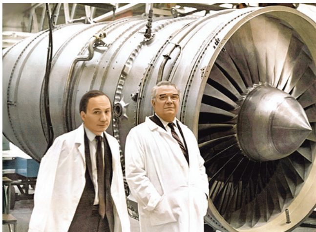
Генеральный конструктор Павел Соловьев и главный конструктор Александр Иноземцев у первого серийного газотурбинного двухконтурного авиадвигателя ПС-90А
